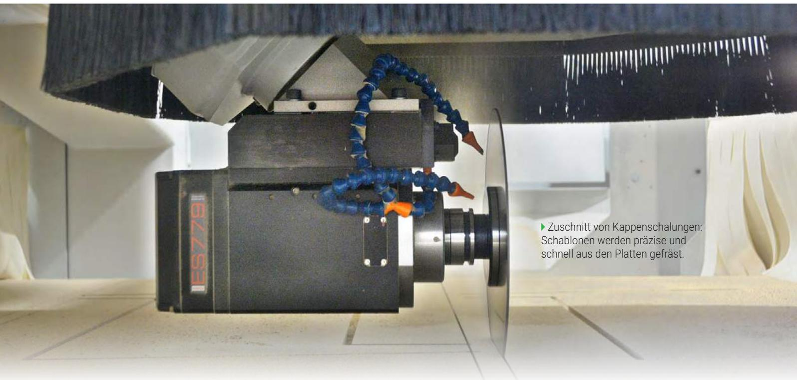
► Zuschnitt von Kappenschalungen: Schablonen werden präzise und schnell aus den Platten gefräst.
