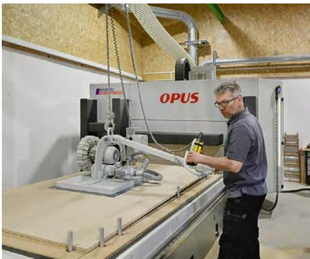
► Das CNC-Bearbeitungszentrum Opus ist aufgrund der offenen Bauweise frei zugänglich für die Bestückung mit Platten von Maßen bis max. 2.500x1.250mm.
