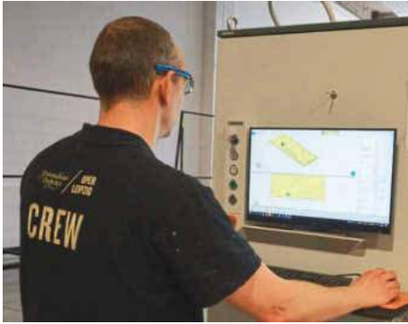
/ Ingo Vater, Tischler und CNC-Fachkraft, kümmert sich um die Fräsarbeiten. In NC-Hops werden ...
