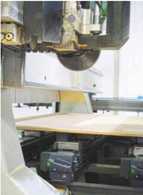
/ Tischlerplatte & Sperrholz sind die Werkstoffe der Wahl. Platten bis 6700 mm Länge passen auf den EPS-Tisch.
