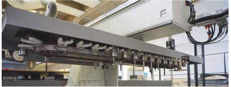
/ ... Werkzeuge zugewiesen. Der 33-teilige Werkzeugwechsler fährt im Betrieb auf der x-Achse mit. So werden die Rüstzeiten deutlich minimiert.
